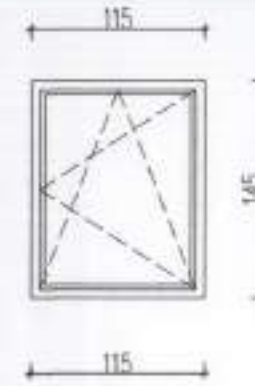
F09 FEREAȘTRA AL CU RUPERE DE PUNTE TERMICA CU GEAM TERMOIZOLANT 8 buc.
