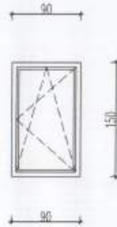
F02 FEREAȘTRA AL CU RUPERE DE PUNTE TERMICA CU GEAM TERMOIZOLANT 2 buc.
