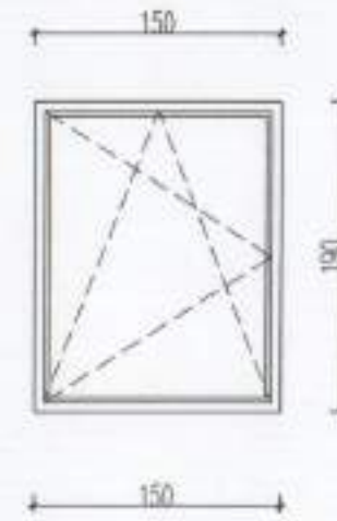
F04 FEREAȘTRA AL CU RUPERE DE PUNTE TERMICA CU GEAM TERMOIZOLANT 3 buc.
