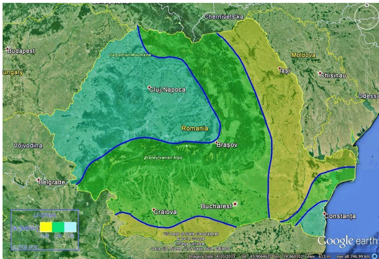
Figura 30 - Zonarea teritoriului României conform STAS 10101/21-92, „Încărcări date de zăpadă”
