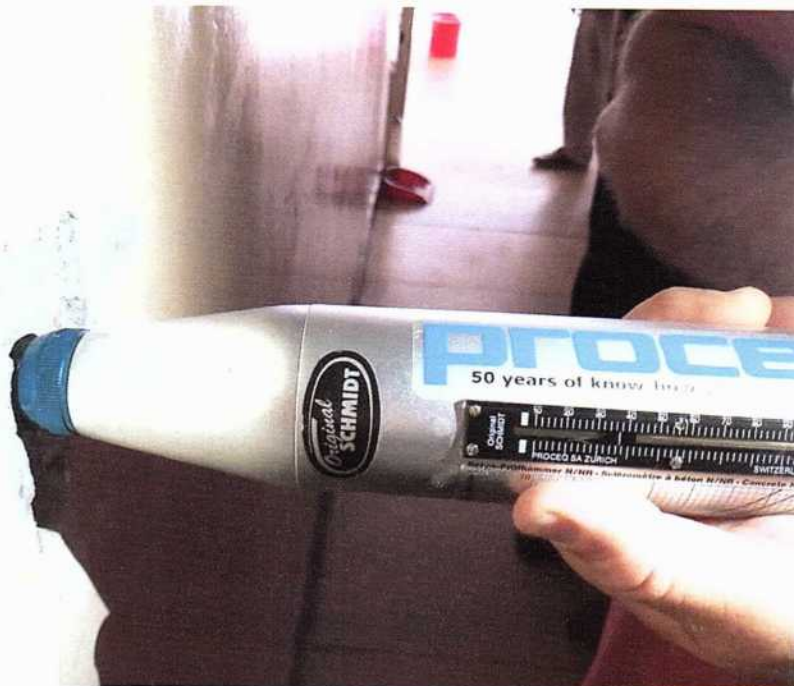
Verificarea rezistenței la compresiune a betonului în stâlpișor, cu sclerometru mecanic
