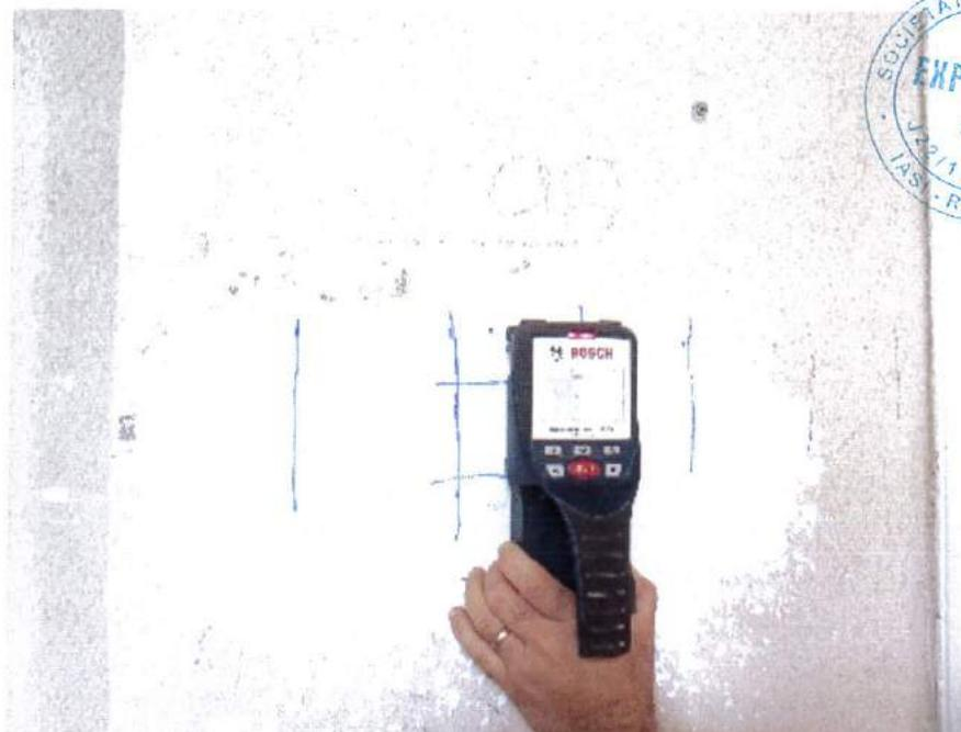
Detectare număr, poziție și diametru armături longitudinale în stâlp din beton armat
