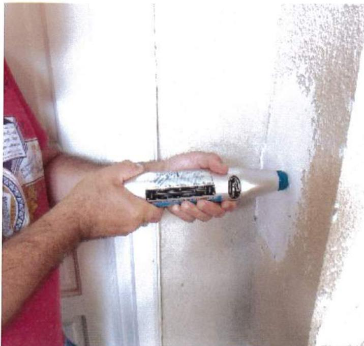
Verificarea rezistenței la compresiune a betonului în stâlp, cu sclerometru mecanic
